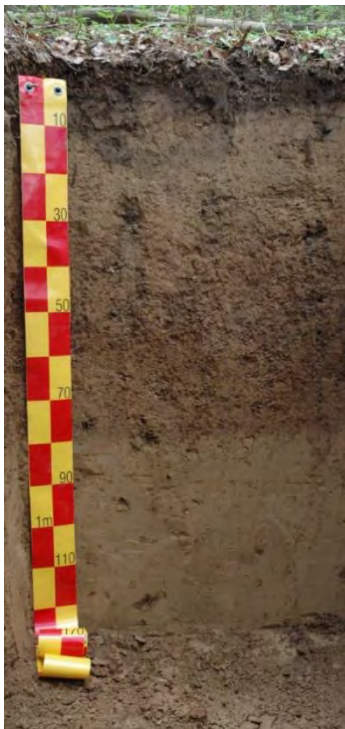
Figura 8-5: Profilo ideale di suolo. Scattare sempre la foto perpendicolarmente alla parete del profilo
