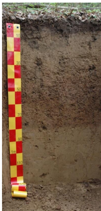
Rycina 8.5: Prawidłowo wykonane zdjęcie profilu glebowego. Zawsze wykonuj zdjęcie prostopadłe do ściany profilu.
